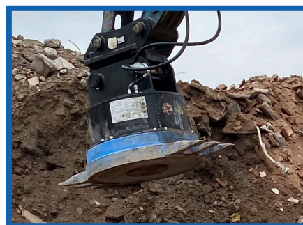
Imán Arden equipado con un enganche rápido
