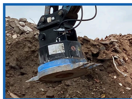
Imán Arden montado en un enganche
